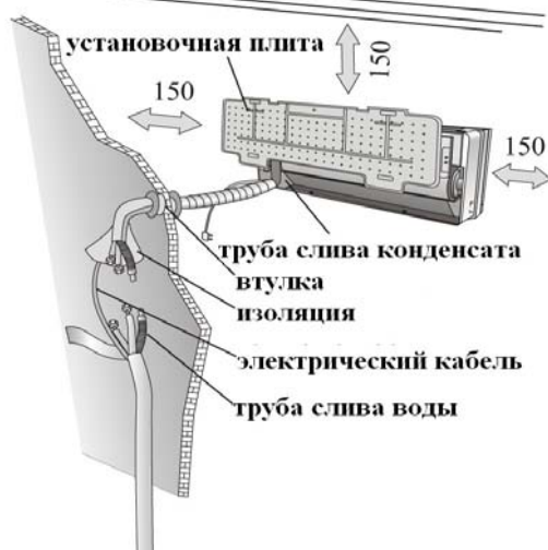
минимальные расстояния до стен, потолка и любых предметов (в мм.)
