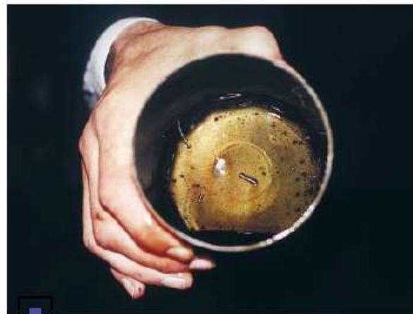
...в его внутренностях обнаруживается «захороненная» стружка
