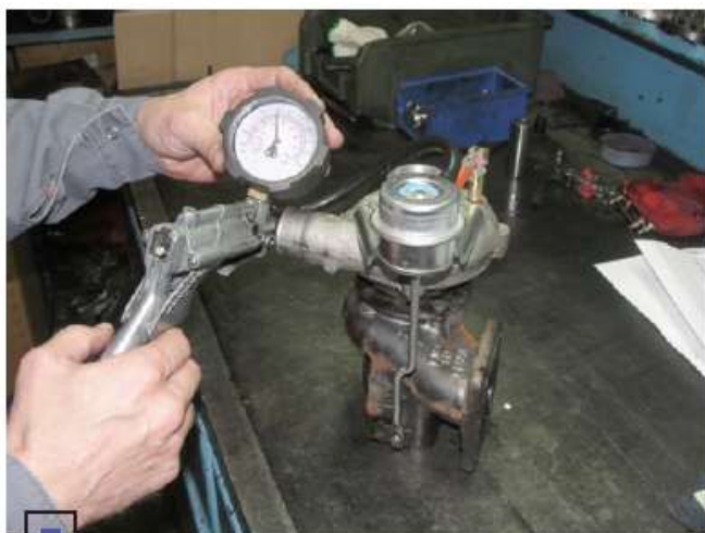
Эксперт проверяет исправность пневматической камеры управления байпасным клапаном
