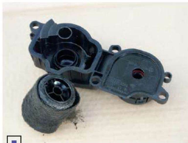
Похоже, фильтр системы вентиляции не менялся с момента его установки на конвейере
