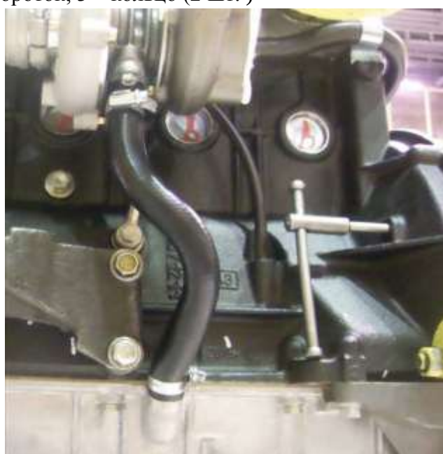
Установка штифта коленчатого вала 3М 7820-4582 для фиксации коленчатого вала в ВМТ
