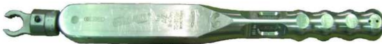
Рис.А.27 – Динамометрический ключ для затяжки гаек топливopоводов высокого давления. Дреометр №7460-01 AZ A+S (0,8-4,0кгсм) Ø 16мм + Вставная накладная насадка с открытым зевом № 8797-17, код 1211706, ф. Gedore.
