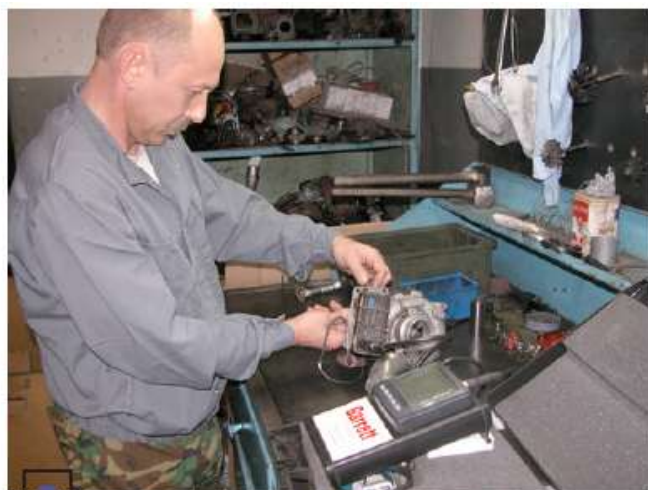
Диагностика электронных турбин возможна только с помощью специализированного тестера
