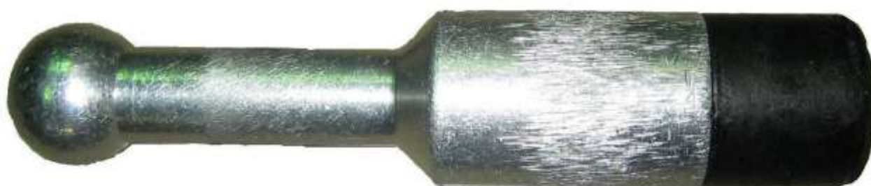
Рис.А.12 – 5-ф-98 Оправка для установки поршневой группы в блок цилиндров
