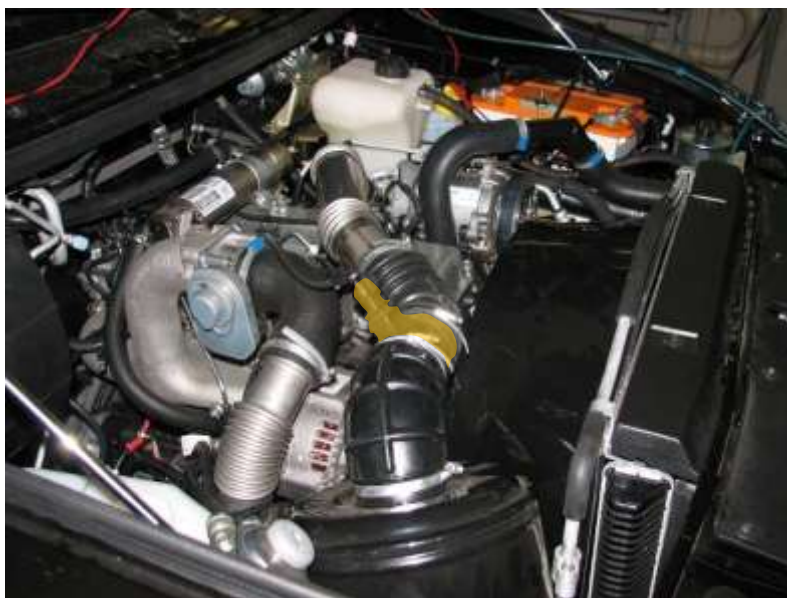
Рис.84. Место размещения ДМРВ в системе впуска
