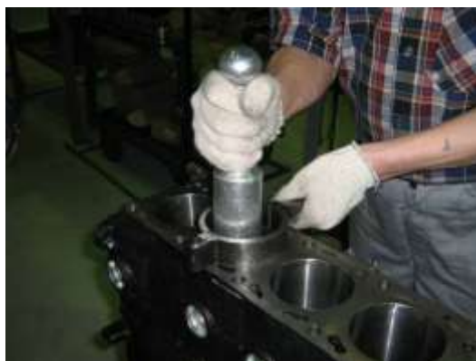
Установка поршневой группы с помощью оправок ЗМ 7853-4306 и 5-ф-98
