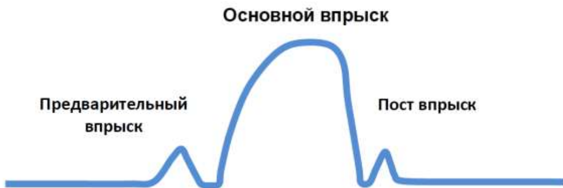
Рис.106. Закон подачи топлива в дизеле 3М3-51432.
