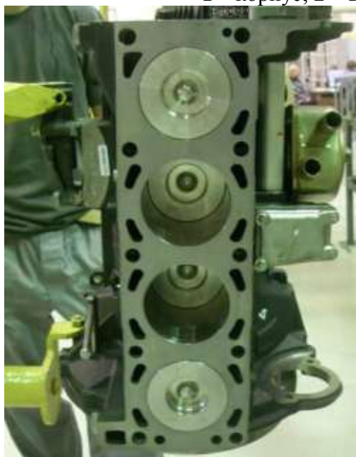
Установка штифта коленчатого вала 3М 7820-4582 для фиксации коленчатого вала в ВМТ
