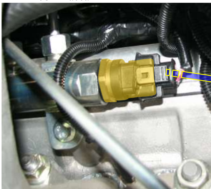
Рис.91. Внешний вид и расположение датчика давления топлива
