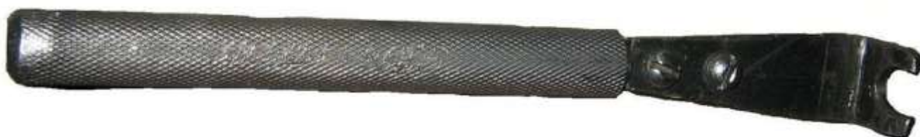
Рис.А.28 – 3М 7823-4655 Оправка для извлечения гидроопор из головки цилиндров
