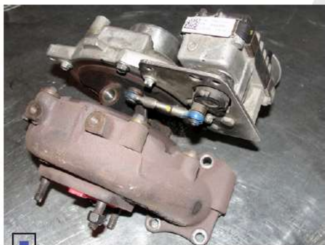
Механизм РСА — в корпусе турбины, а его привод закреплен на улитке компрессора. Изменение разворота корпусов нарушит настройки механизма регулирования
