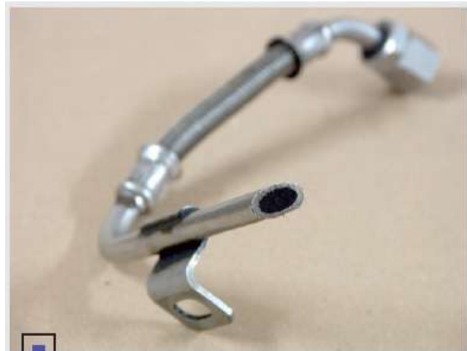
Сэкономил на маслоподающей трубке — загубил турбину
