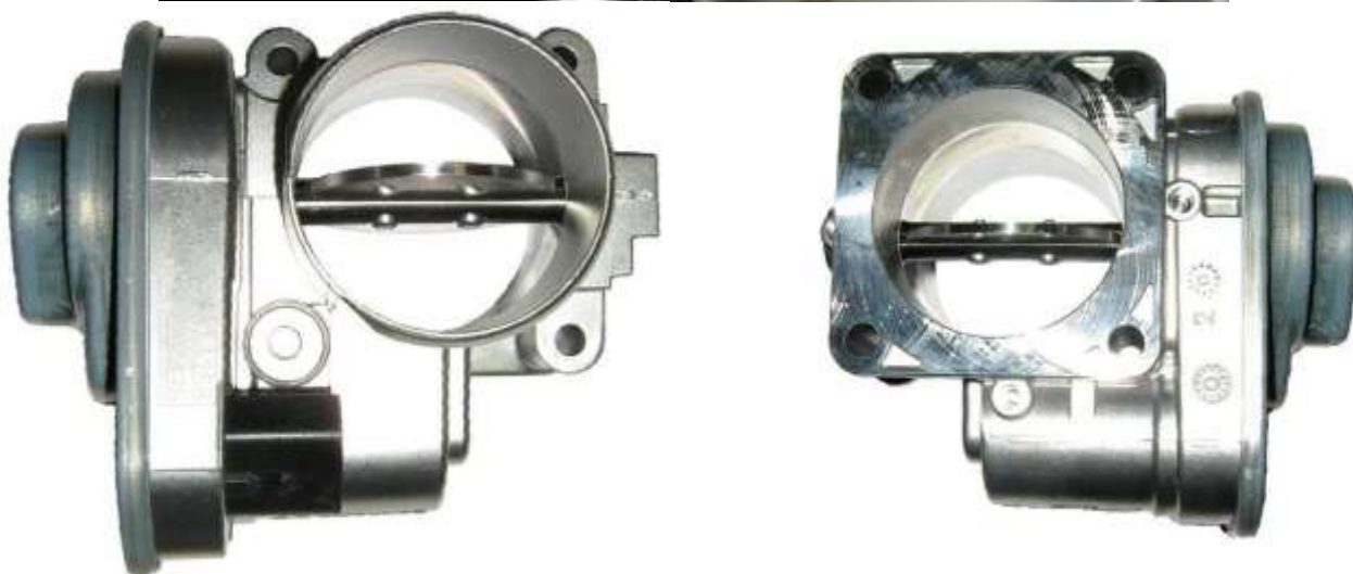
Рис.94. Внешний вид воздухоподающего патрубка с дроссельной заслонкой
