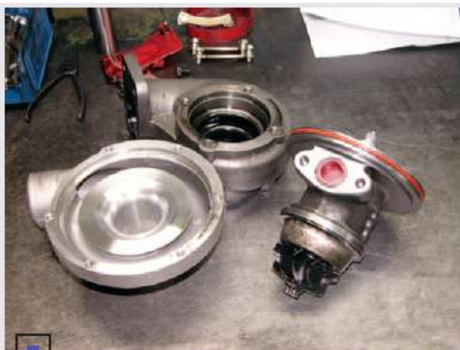
Еще бы она не потекла — «монтажники» присоединили трубку для слива масла, забыв удалить пластиковую технологическую заглушку!
