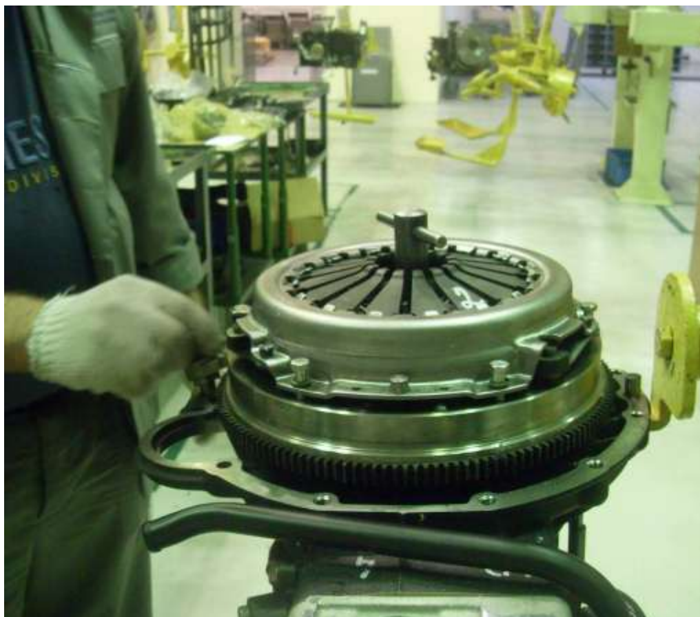
Установка фиксатора коленчатого вала ЗМ 7820-4550
