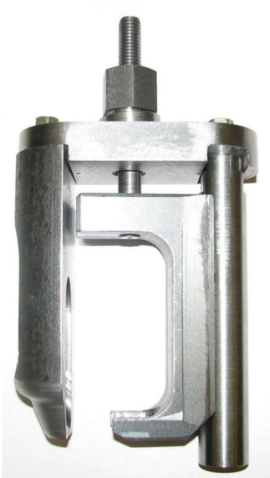
Рис.А.24 – ЗМ 7823-4832 Съемник для извлечения топливной форсунки из головки цилиндров
